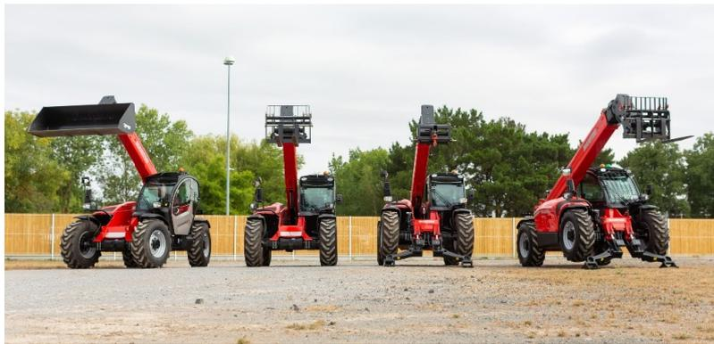
mètres sont proposés avec deux versions de transmission convertisseur de couple ou hydrostatique pour répondre aux différents besoins de ses utilisateurs. Deux motorisations sont aussi proposées pour ces mêmes modèles avec une version 75 ch ou 100 ch. Ces télescopiques sont ainsi équipés du même tableau de bord que le reste de la gamme avec un écran Harmony, ainsi que la possibilité de déplacer ses boutons de commandes près de l'accoudoir (Double Switch Buttons).
