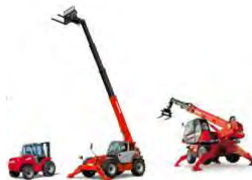
Chariot à mât      Chariot télescopique fixe      Chariot télescopique rotatif
