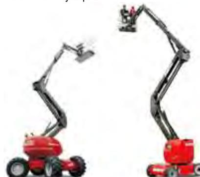
Nacelle thermique tout terrain      Nacelle électrique
