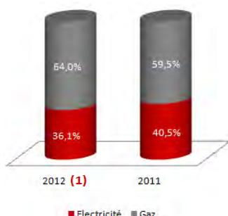
L'électricité est utilisée principalement pour le fonctionnement des moyens de production, mais aussi pour l'éclairage et le chauffage électrique de quelques bureaux. Quant au gaz, il est utilisé pour le chauffage des ateliers et la cuisson des peintures. C'est en analysant les consommations de gaz sur les périodes hivernales et estivales que l'on observe une forte influence de la consommation de gaz par rapport aux températures extérieures.
