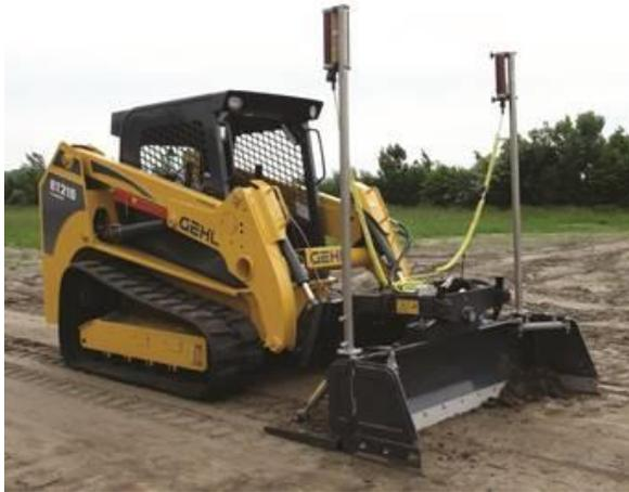
Les marques Gehl et Mustang se voient dotées d'une **nouvelle lame de nivellement à double sens**.
