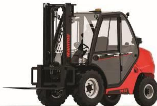
hauteur de l'opérateur. Avec leur transmission hydrostatique, ces nouveaux MSI peuvent atteindre une vitesse maximale de 22km/h, soit 4km/h de plus que l'ancienne génération, faisant de ces machines les plus rapides du marché.
